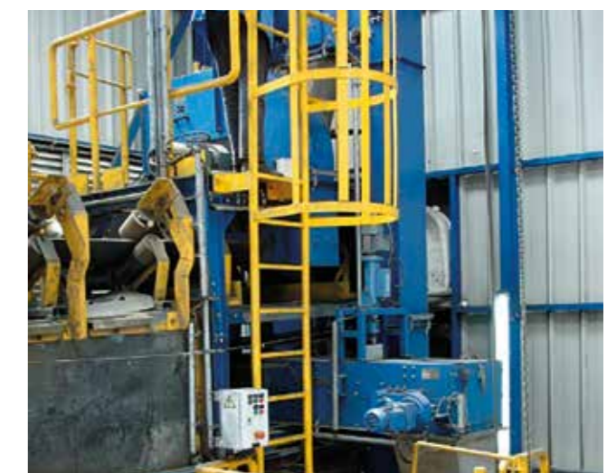
Система отбора проб медного концентрата
